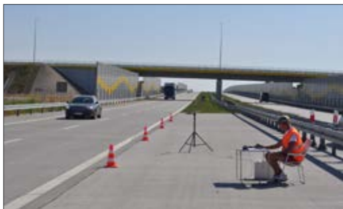
Rys. 1. Pomiary maksymalnego poziomu dźwięku metodą SPB (Statistical Pass-By method) (fot. dr inż. Marek Motylewicz)
